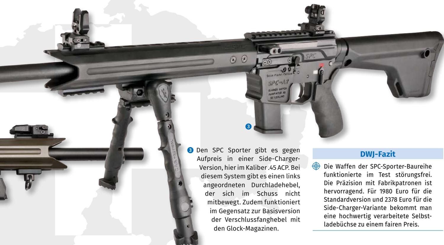
3 Den SPC Sporter gibt es gegen Aufpreis in einer Side-Charger-Version, hier im Kaliber .45 ACP. Bei diesem System gibt es einen links angeordneten Durchladehebel, der sich im Schuss nicht mitbewegt. Zudem funktioniert im Gegensatz zur Basisversion der Verschlussfanghebel mit den Glock-Magazinen.
